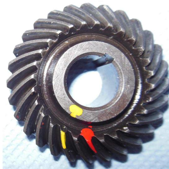
Beim Einbau in 750er Rundmotoren wird die originale Markierung Beibehalten (hier gelb markiert), sprich „plug & play“
